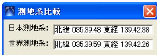
座標を知りたい位置にマウスを合わせると、日本測地系、世界測地系の緯度経度座標が瞬時に表示されます。
